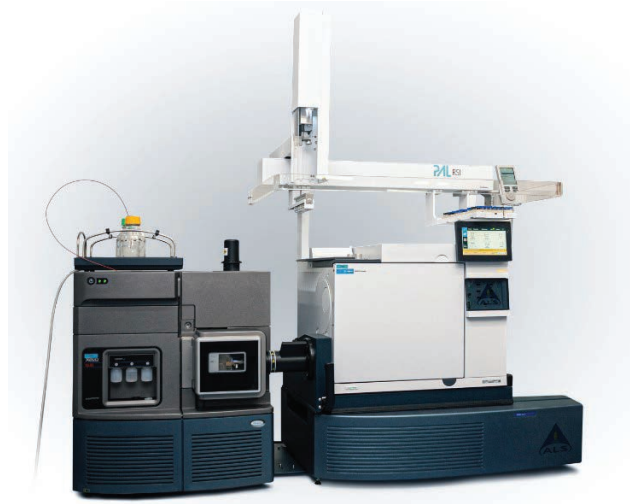
Waters Xevo TQ-XS APGC Mass Spectrometer at ALS Brisbane
